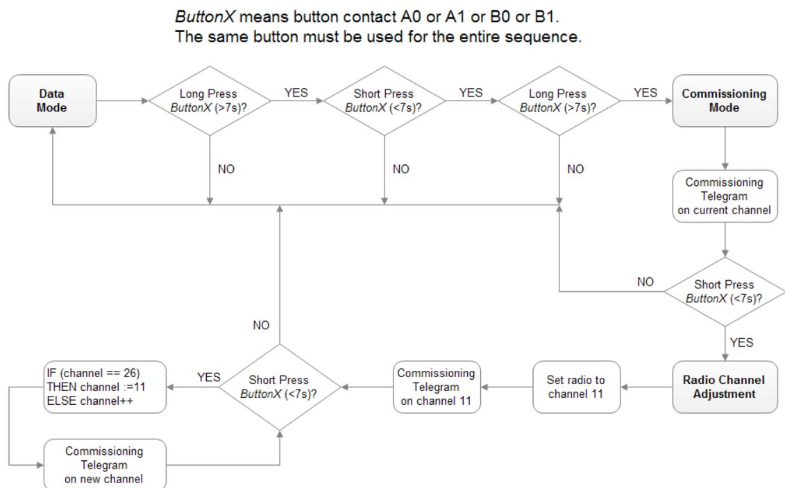
Um eine Inbetriebnahmeanfrage zu senden, wählen Sie zunächst einen Tastenkontakt des PTM 216Z. Jeder Kontakt von PTM 216Z (A0, A1, B0, B1) kann verwendet werden (daher funktioniert die sequenzielle Inbetriebnahme auch für einzelne Wippenkonstruktionen). Dieser Kontakt wird in Abbildung 14 oben als ButtonX bezeichnet.
